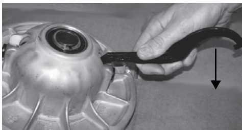
Zum Auseinanderspreizen der Riemenscheiben Druck auf das andere Ende des Werkzeugs ausüben.
